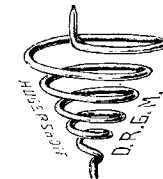
Die Flüssigkeit dringt an den freien Stellen zwischen den Windungen durch das Papier hindurch und läuft herunter, bis sie auf die Spirale trifft, an der entlang sie im schnellen Strome nach unten geführt wird, ohne sich jemals zu stauen, wie dies bei Faltenfiltern oder den sogen. Patent-trichtern eintritt. Flüssigkeit, die sich einmal an den Spiralen gesammelt hat, kommt nicht wieder mit dem Filter in Berührung. Die Schnelligkeit des Filtrierens wird also erhöht.
